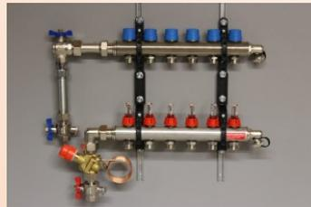
Festwertregelset 3/4", FIX m. TacoFlow2 25-60/130 best. aus Thermostatischem Mischventil, Pumpe mit digitalem Display, Anschlusswinkel mit KFE-Hahn und Thermometer
