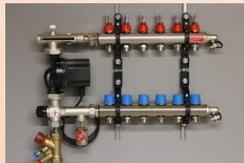
Festwertregelset 3/4", m. TacoFlow2 25-60/130 best. aus Thermostatventil, Fernfühler, Pumpe mit digitalem Display, Sicherheitstemp. begrenzer, Anschlusswinkel mit KFE-Hahn und Thermometer
